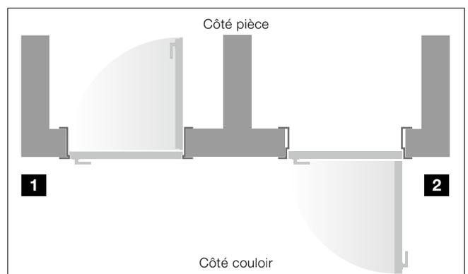
La porte à ouverture réversible (DIN gauche) s'ouvre sur la pièce **1** et la porte affleurante à ouverture normale (DIN droite) s'ouvre sur le couloir **2**
