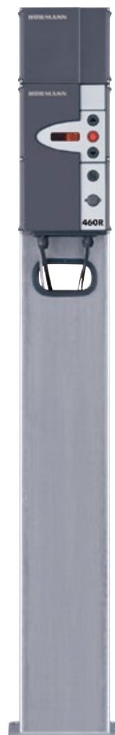
Optioneel: standzuil STI 1 Voor de montage van max. 2 besturingen met extra behuizing, kleur: blank aluminiumkleurig, RAL 9006, afmetingen: 200 × 1660 × 60 mm (B × H × D)
