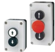
Druknopswitchakelaar 2-voudig "OPEN-DICHT" of 3-voudig "OPEN/NOODSTOP/DICHT", kunststof behuizing, IP65
