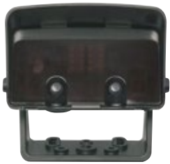
Radarbewegingsmelder MWD-C snelle en gerichte automatische garagedeuropening, richtingsherkendend, max. montagehoogte 7 m, montage in vriescel mogelijk tot maximaal -22 °C, IP65
