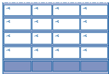
Sectionaaldeur ALR F42 met hetzelfde aanzicht als deuren met loopdeur
