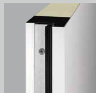
De universele deur MZ Thermo onderscheidt zich door een 46 mm dik deurblad en een warmte-isolatiewaarde van tot wel 1,1 \text{ W}/(\text{m}^2 \cdot \text{K}) .
