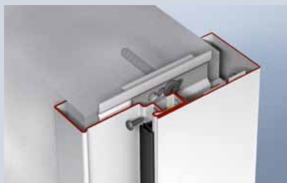
Vissage du profilé de contre-huisserie 2 sur l' huisserie du profilé 1 à travers la rainure d'étanchéité, puis recouvrement avec le joint de porte
