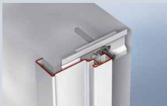
Vissage du profilé d' huisserie d'angle 1 dans l'ossature métallique
