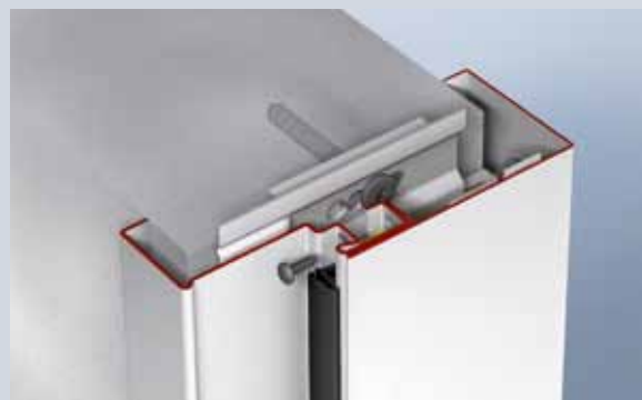
Tegenkozijn-profiel 2 van het kozijn door de afdichtingsgleuf op profiel 1 vastschroeven en met het afdichtingsprofiel bedekken
