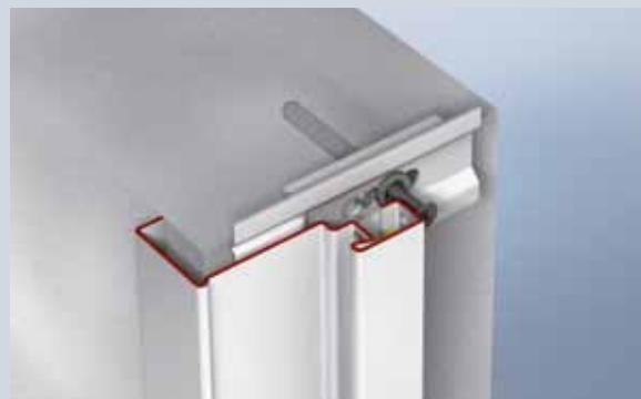
Hoekkozijn-profiel 1 vastschroeven op de scheidingswand
